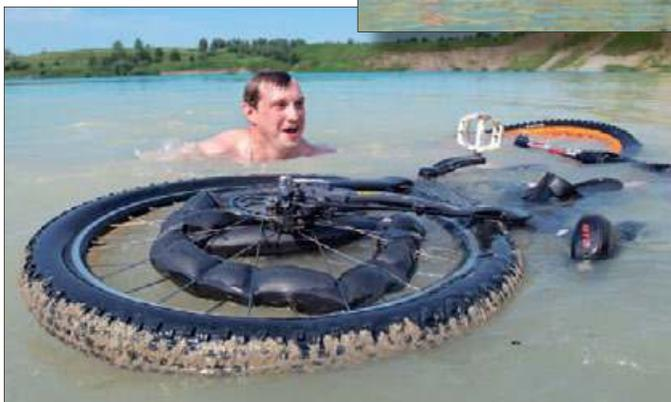
Чтобы велосипед сразу не тонул, повышают его плавучесть: между спиц вставляют и надувают камеру, привязывают к раме блоки пенопласта и пустые пластиковые бутылки.
